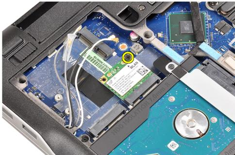
5. 滑动 WLAN 卡并将其从系统板上的插槽卸下。
