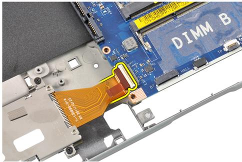
5. 拔下电源连接器电缆。
