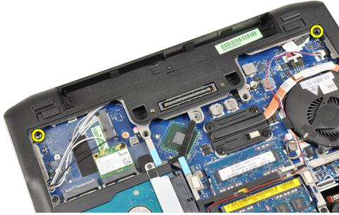
4. 断开可能连接到无线解决方案的任何天线电缆，将其从布线通道中卸下。
