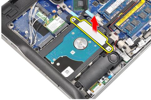
5. 使用平头螺丝刀以提起硬盘驱动器的边缘。
