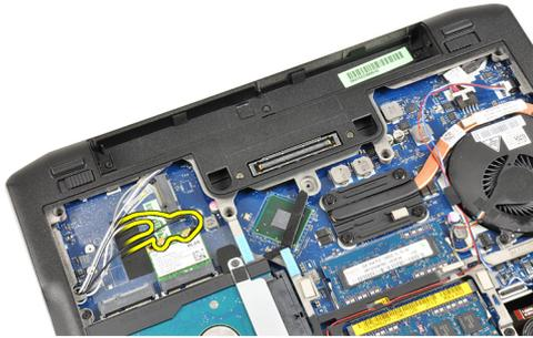
5. 拧下用于将低压差分信号 (LVDS) 支架固定至计算机的螺钉。
