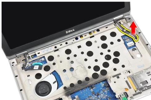
9. 卸下将显示屏部件固定至计算机的螺钉。
