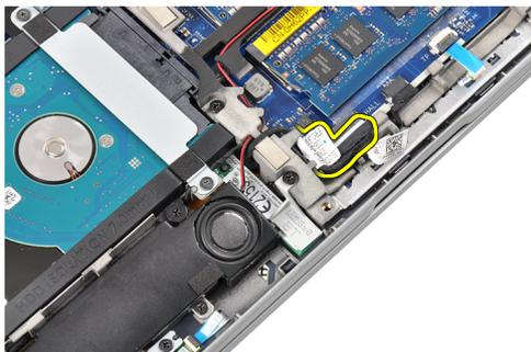
4. 拧下用于将蓝牙模块固定至计算机的螺钉。
