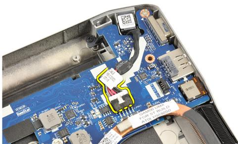
4. 卸下电源连接器端口。
