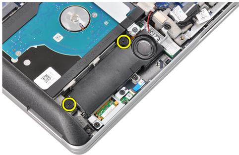
6. 拧下将其它扬声器固定到计算机的螺钉。
