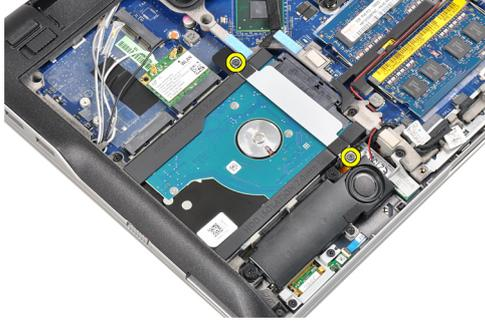
4. 卸下将硬盘驱动器固定至计算机的硬盘驱动器支架。
