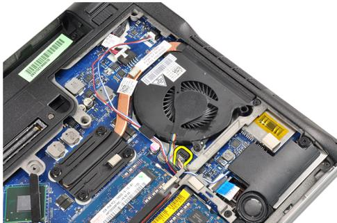
4. 拧下将散热器风扇固定至计算机的螺钉。
