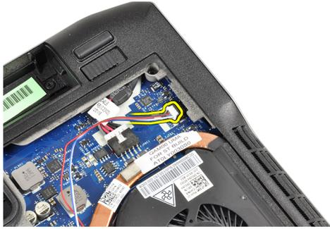
4. 将扬声器电缆从布线通道中拔出。
