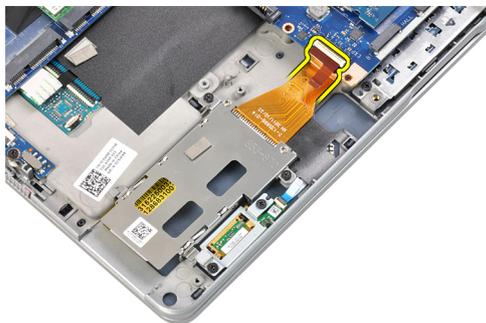
4. 拧下用于将 ExpressCard 固定框架固定至计算机的螺钉。
