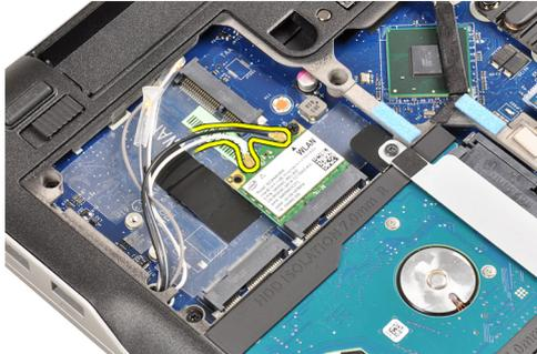
4. 拧下将 WLAN 卡固定到计算机的螺钉。
