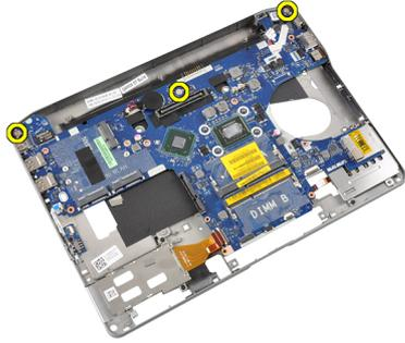
7. 将系统板部件的左侧边缘提起，并提起到 45 度角。
