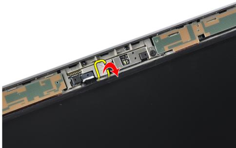
4. 拧下用于将摄像头固定到显示屏部件的螺钉。
