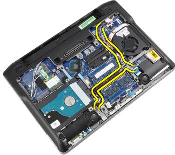
5. 拧下将扬声器固定到计算机的螺钉。
